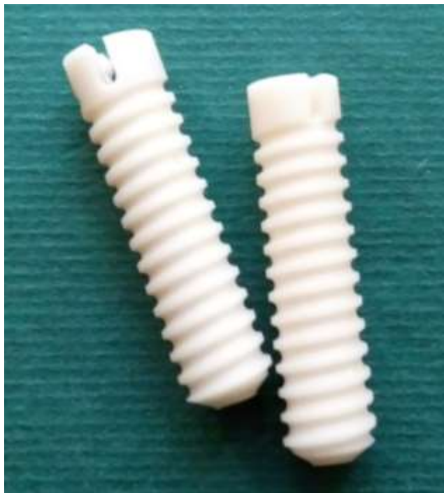
Винт из композита полилактид-ГАП 6x20 мм
