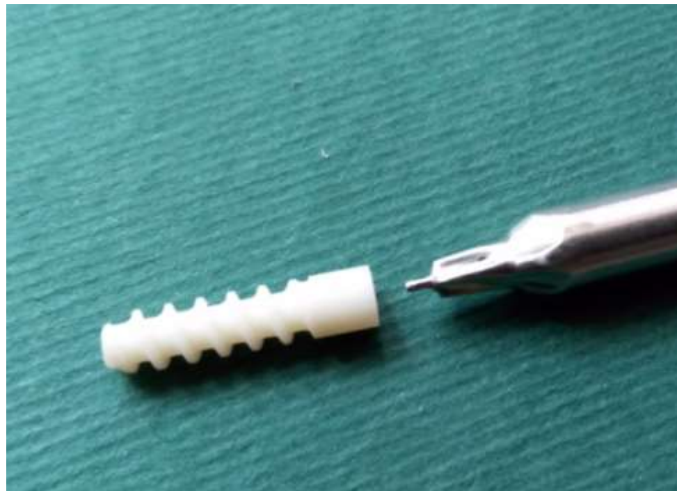
Винт из композита полилактид-ГАП 4x25 мм; инструмент для вкручивания
