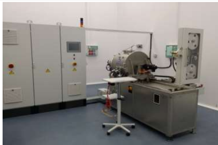
Установка термического осаждения серебра
